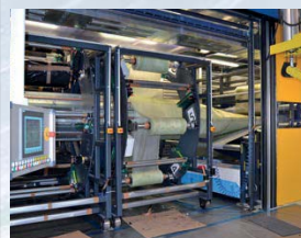
Gigantische Ausmaße: Ein 4 m großer Wickelkörper rotiert um die Zunge und wickelt die vorimprägnierten Glasfaserbahnen um die Schlauchfolie.
