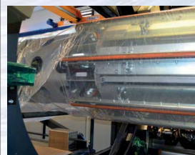
Die 10 m langen beschichteten BRECOFLEX® BAT-Polyurethan Zahnriemen halten die Schlauchfolie in Form und transportieren sie nach vorne zur Wickelstation.
