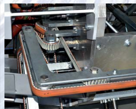
Angepasst: Die widerstandsfähige Linatrilite-Beschichtung ist entsprechend der Kontur der Umlenkrollen geschliffen.
