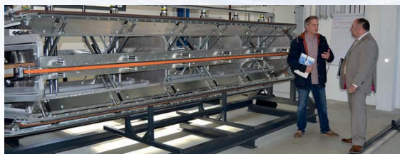
Mannhoch: Die „Zunge“ ist im Durchmesser von 1.200 bis 1.600 mm verstellbar. Dabei sind die Umlenkrollen der Zahnriemenantriebe so angeordnet, dass die Umschlingungslänge für die Zahnriemen konstant bleibt.
