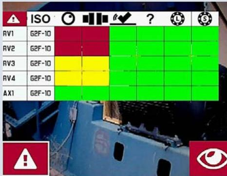
VSHOOTER® analysiert den Maschinenzustand und stellt das Analyseergebnis als MCP-Protokoll (MCP = Machine Condition Picture) farblich dar (Grün/Gelb/Orange/Rot). Die Auswertung der Schwingungen erfolgt automatisch und wird nach der ISO 10816 bewertet und dargestellt.
