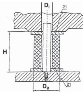
b) mit Federteller und Führungsbolzen
